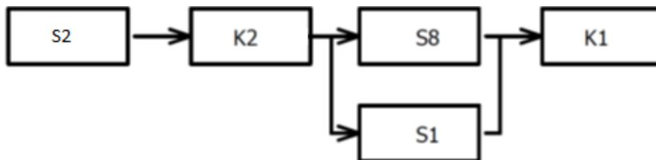
Figura 42: Representação de blocos - prevenção de partida inesperada
