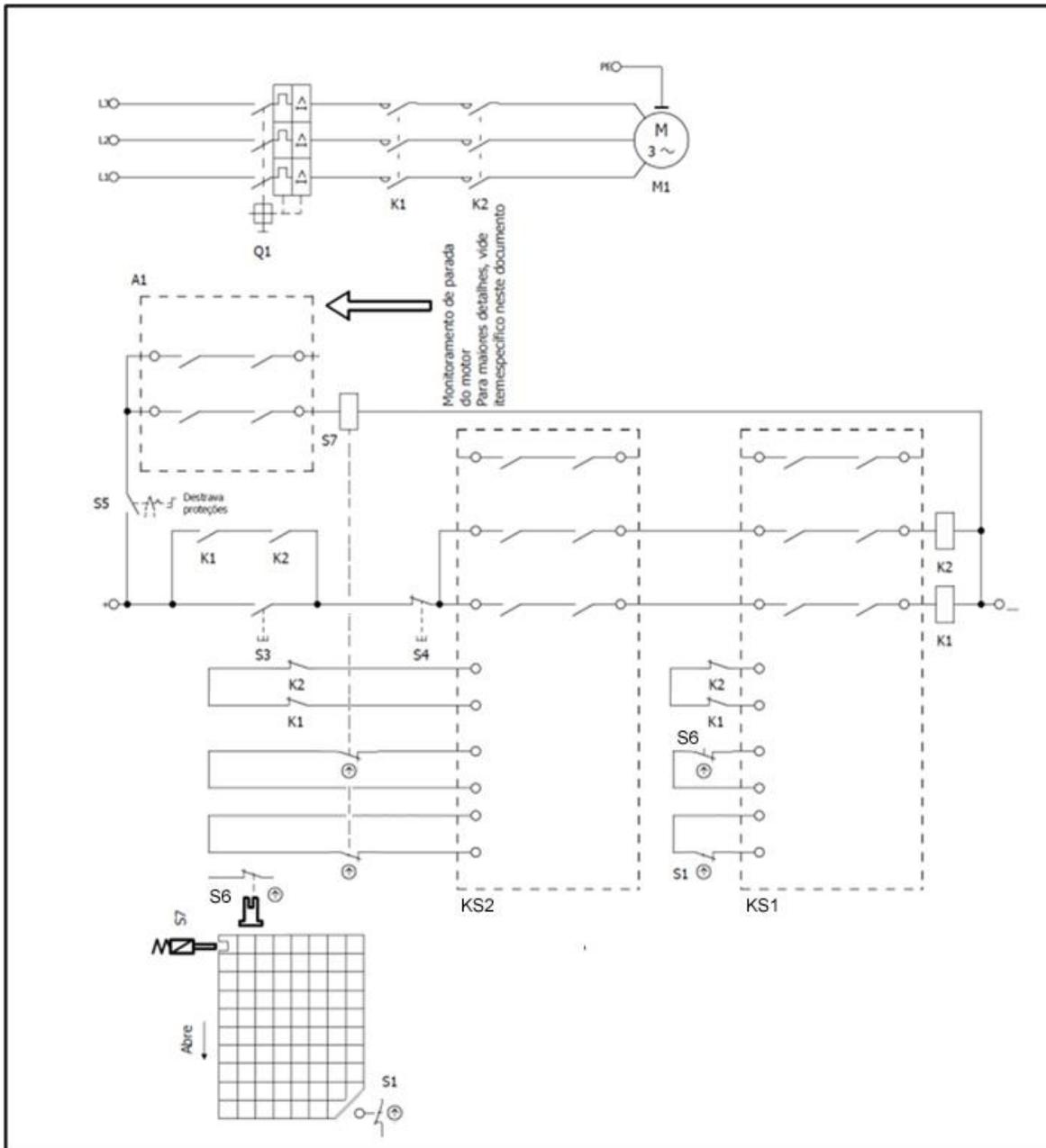
**Figura 89: Circuito elétrico**
