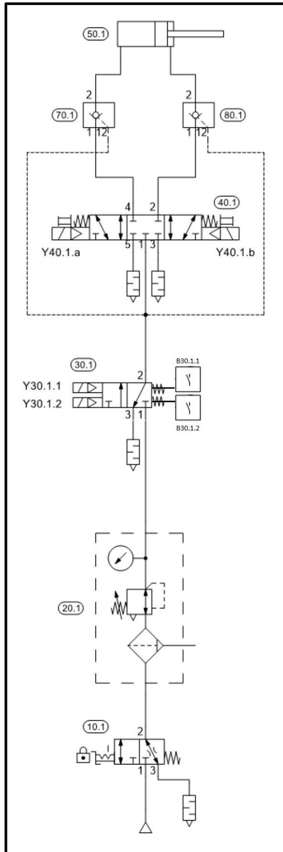
Figura 101: Circuito pneumático
