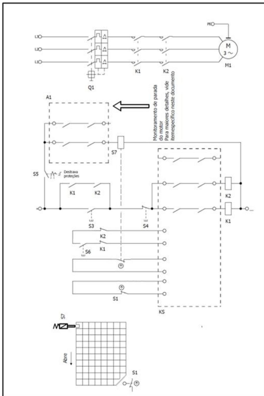
Figura 88: Circuito elétrico
