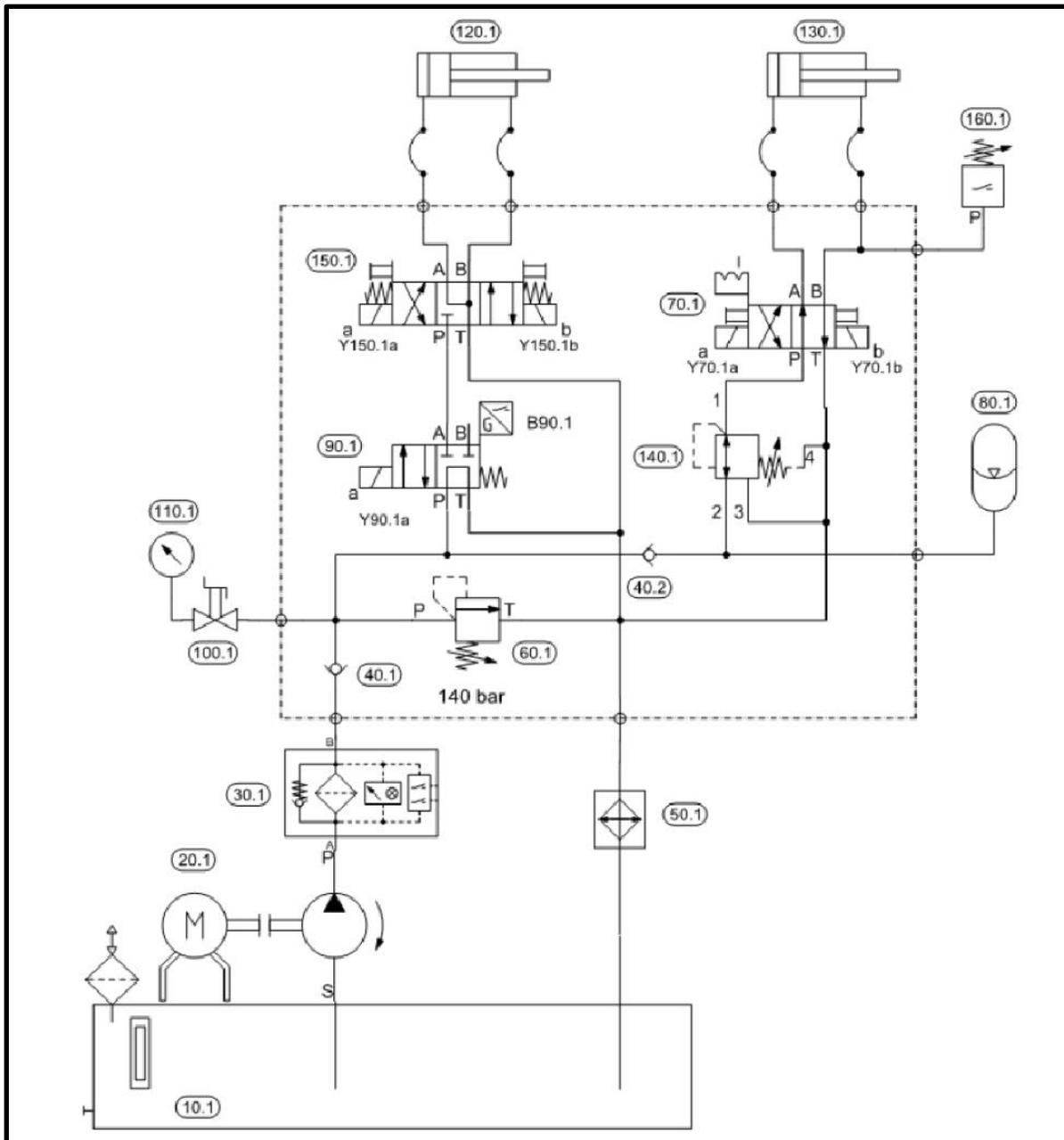
Figura 63: Circuito hidráulico
