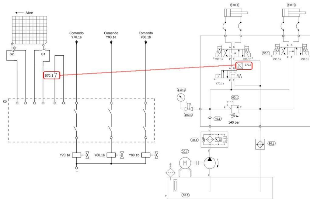
Figura 6: Monitoramento dinâmico da válvula de bloqueio
