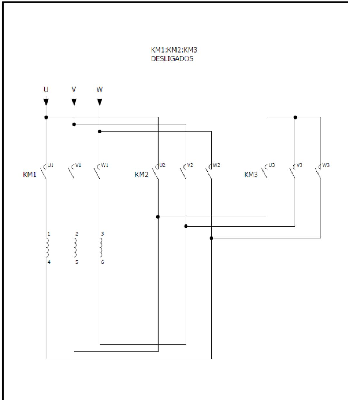
Figura 17: Circuito elétrico da partida estrela-triângulo
